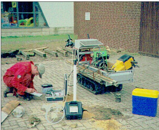
Besteht die Möglichkeit, dass im Boden flüchtige, gasförmige Schadstoffe von Lösemitteln enthalten sind, kann die Bodenluft abgesaugt und vor Ort vermessen werden.
